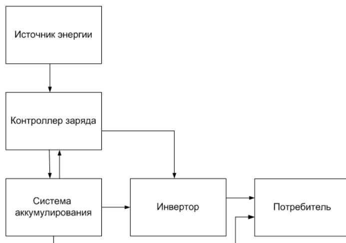
Рис. 2. Стандартная структура системы распределения электроэнергии
