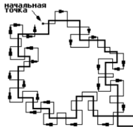
Рис. 1. Пример отслеживания внешнего контура, где начальная точка расположена вверху слева
