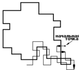
Рис. 2. Пример отслеживания внешнего контура, где начальная точка расположена внизу справа
