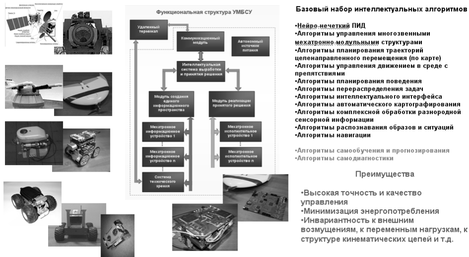
Рис. 2. Аппаратная реализация унифицированной многопроцессорной интеллектуальной бортовой системы управления и примеры ее применения в составе автономных подвижных объектов различных типов и назначения
