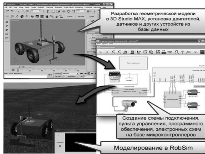
Рис. 6. Фрагменты этапов проектирования и комплексного моделирования автономного мобильного робота в среде «RobSim»
