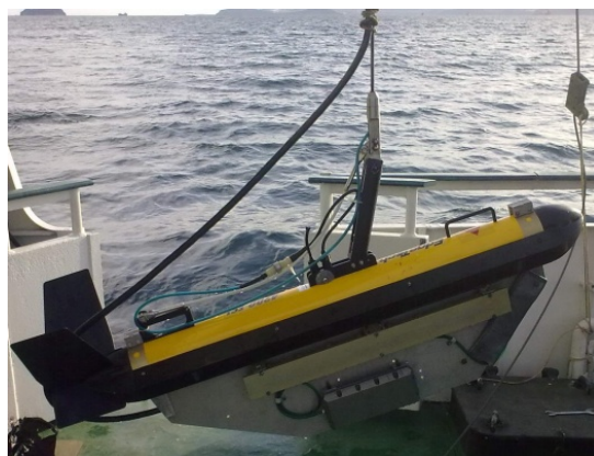
Рис. 2. Внешний вид буксируемого устройства с модифицированным макетом антенной платформы
