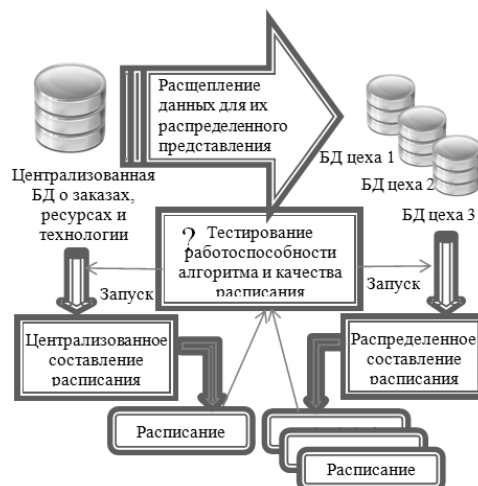
Рис. 3. Архитектура системы тестирования и оценки качества работы алгоритма координации локальных расписаний
