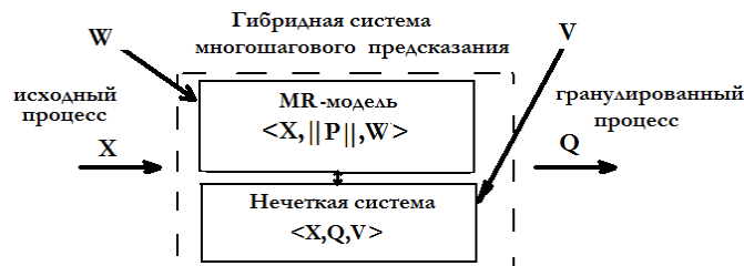
Рис. 3. Гибридная система многошагового предсказания с двумя группами модифицируемых параметров
