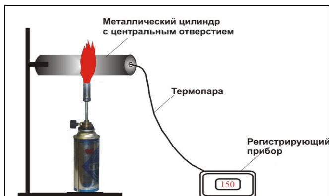
Рис. 5. Установка для оценки теплоизолирующих свойств ОЗВП
