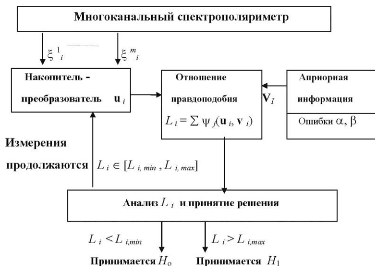
Рис. 4. Процедура последовательного анализа для различения гипотез H_0 и H_1
