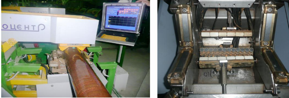
Рис. 1. Установка ультразвукового толщиномера-дефектоскопа «ДЭКОТ» и конструкция иммерсионной ванны с пьезоэлектрическими преобразователями
