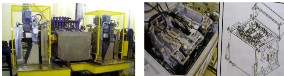
Рис. 4. Система ультразвукового контроля труб без вращения трубы компании OLYMPUS NDT, R/D Tech
