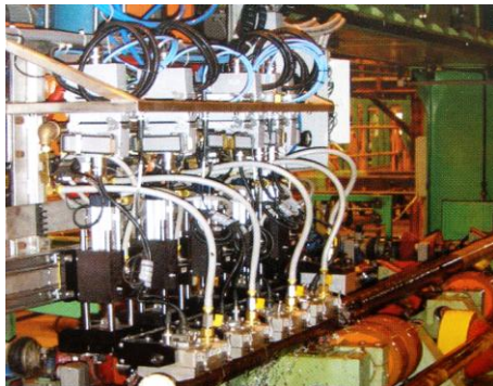
Рис. 3. Система ультразвукового контроля труб с вращением трубы компании OLYMPUS NDT, R/D Tech
