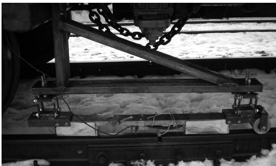
Рис. 10. Система намагничивания в рабочем состоянии
