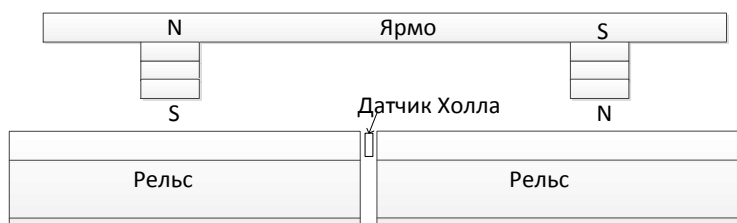
Рис. 8. Структура системы намагничивания для исследования зависимости силы намагничивающего поля от числа последовательно соединенных магнитов
