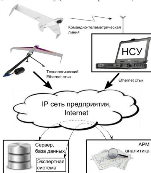
Рис. 3. Функциональная схема сбора данных с БПЛА и последующего анализа
