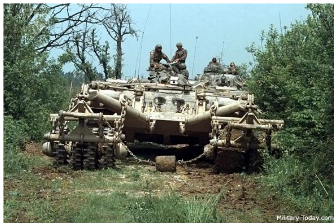
Рис. 3. Танк-тральщик Panther M60, оборудованный катковым тралом
