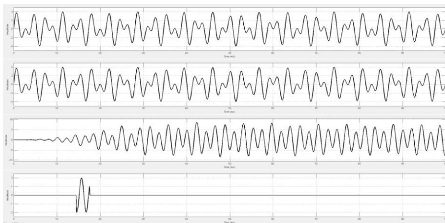
Рис. 6. Осциллограммы работ безопасного радиочастотного логического элемента «ИЛИ»
