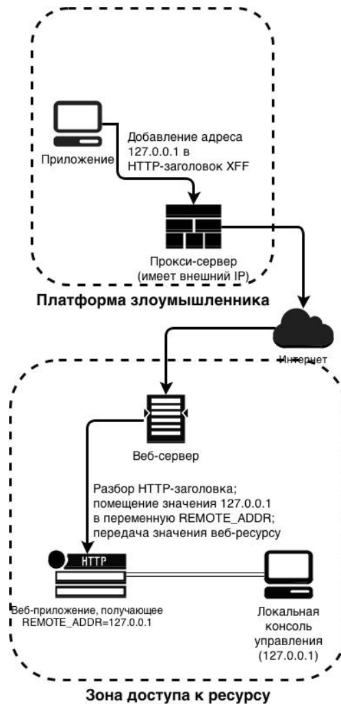
Рис. 2. Доступ злоумышленника к веб-ресурсу через передачу значения 127.0.0.1 в заголовке XFF
