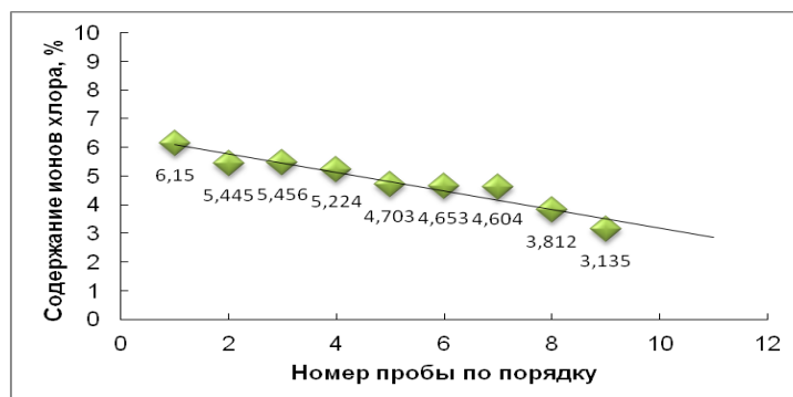
Рис. 1. Динамика изменения содержания иона хлора в электролите
