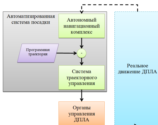
Рис. 1. Структурная схема автоматизированной системы посадки
