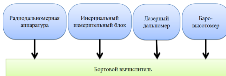
Рис. 2. Схема макета автономного навигационного комплекса
