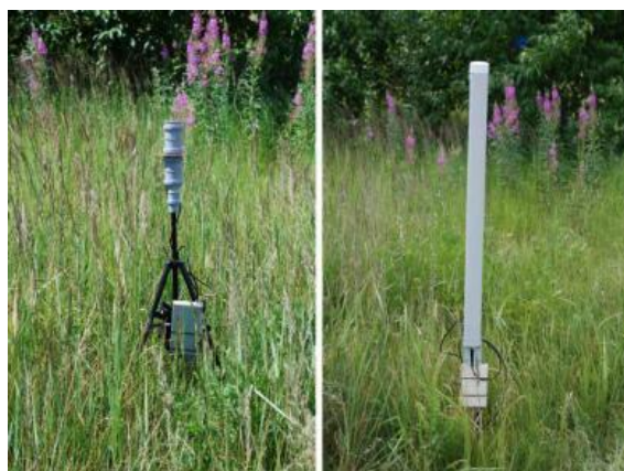
Рис. 5. Установка НРМ в окрестности ВПП: а – макет; б – перспективный блок
