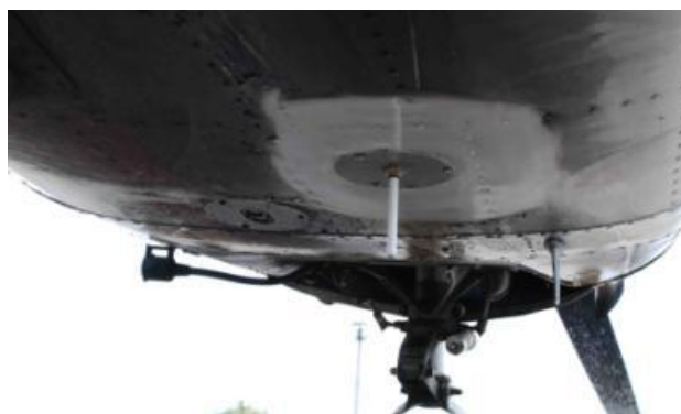
Рис. 4. Установка антенны РДА и дальномера на самолете
