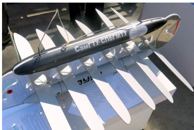
Рис. 4. Подводный модуль волнового глайдера СамГТУ-СПБГМТУ
