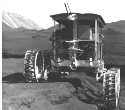
Рис. 1. Фрагменты испытаний ходовых макетов с КШД: КШМ (слева, режим колесного шагания), ЭО САШ (колесный режим с адаптацией)
