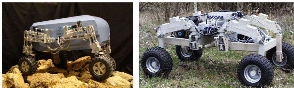
Рис. 5. Четырех опорные шасси с колесно-шагающим движителем: Hyllos II (слева) и WorkPartner
