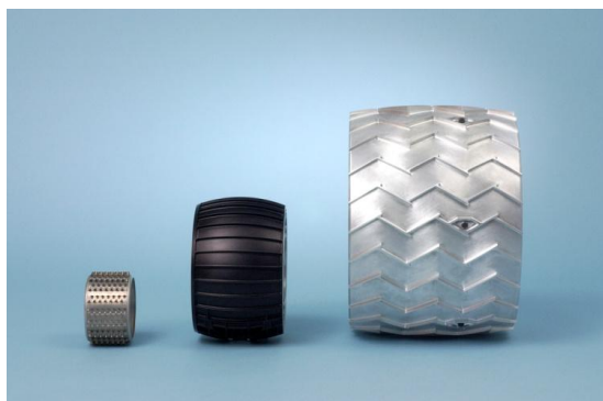
Рис. 2. Колеса американских марсоходов диаметром (слева направо): 0,13 м; 0,26 м и 0,50 м
