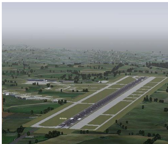
Рис. 3. Пример изображения (компьютерной модели) ВПП в поле зрения камеры, установленной на борту ЛА
