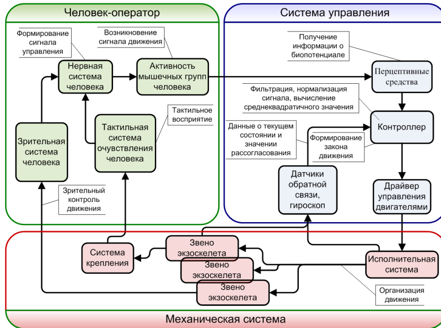
Рис. 2 Функциональная модель экзоскелетного устройства
