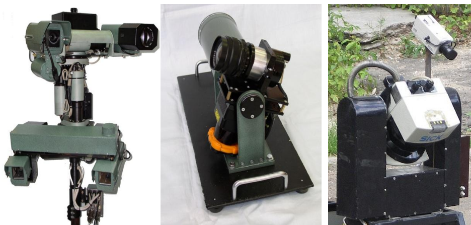
Рис. 2. Комплексированные системы технического зрения для управления наземными РТК: а – комбинированная СТЗ ближнего и дальнего действия; б – СТЗ на базе телевизионной и дальнометрической информации ближнего действия; в – СТЗ на базе телевизионной и дальнометрической информации дальнего действия
