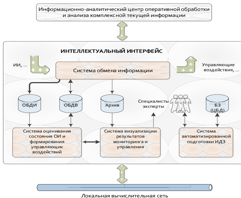
Рис. 6. Использование интеллектуального интерфейса при проектировании распределенного комплекса мониторинга и управления
