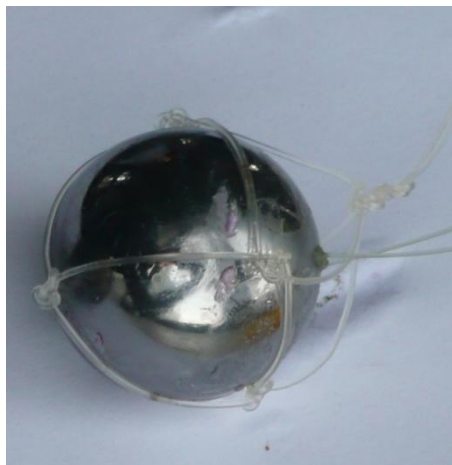
Рис. 6. Сфера из карбида вольфрама для калибровки ПГЛС
