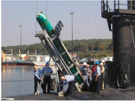
Рис. 3. Процесс загрузки системы AN/BLQ-11 на борт ПЛ [7]
