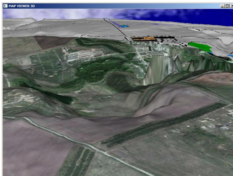
Рис. 2. Реализация алгоритма моделирования рельефа местности с применением карты высот
