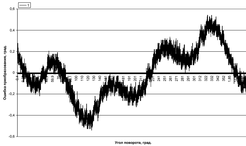
Рис. 5. График ошибки преобразования на полный оборот энкодера. 1 – ошибка преобразования угла, градусы
