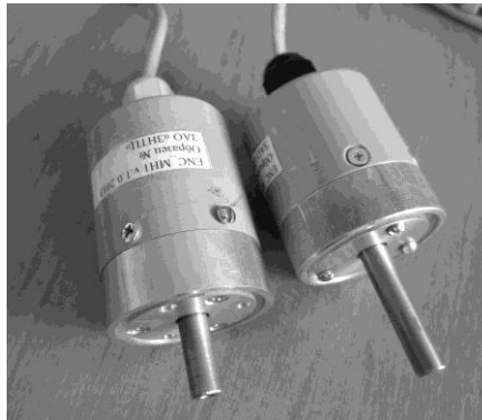
Рис. 4. Энкодер углового положения на основе микросхемы K1382HX045
