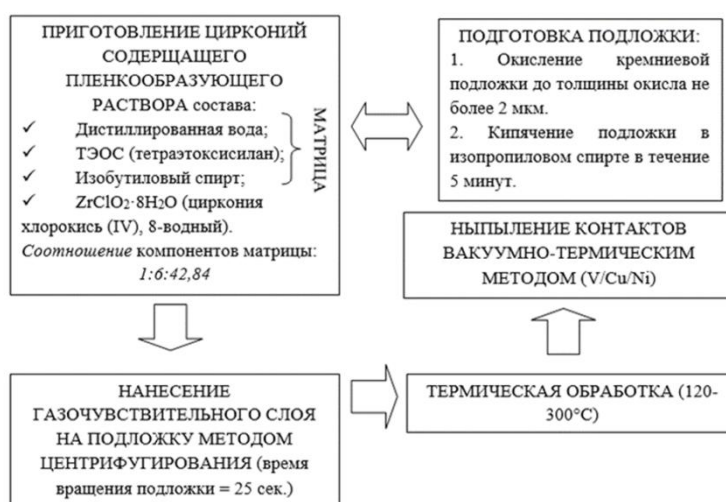
Рис. 1. Технологическая схема получения нанокompозитных материалов состава \text{SiO}_2\text{ZrO}_x сенсорного элемента на их основе
