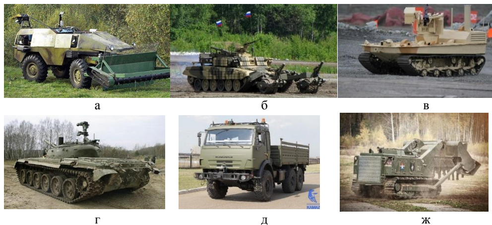
Рис. 1. Роботизированные ТС разработанных в РФ: а – транспортный робототехнический комплекс «КЛАВИР» [11]; б – дистанционно-управляемый робототехнический комплекс разминирования [11]; в – мобильный робототехнический комплекс «МРК-002-БГ-57» [12]; г – транспортный робототехнический комплекс «АЛИСА» [11]; д - беспилотный автомобиль «КАМАЗ» [13]; ж – робототехнический комплекс разминирования «УРАН-6» [14]
