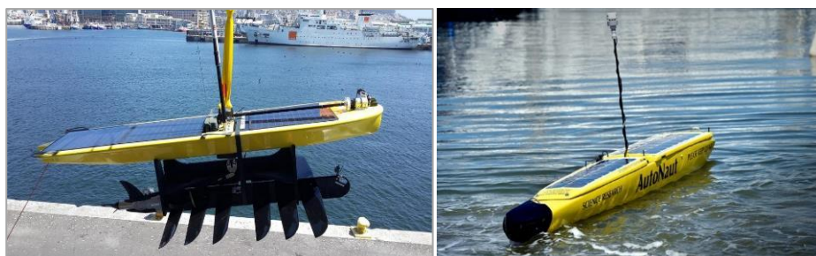
Рис. 2. Подкласс надводных (волновых) глайдеров (LR SV3 series, AutoNaut)
