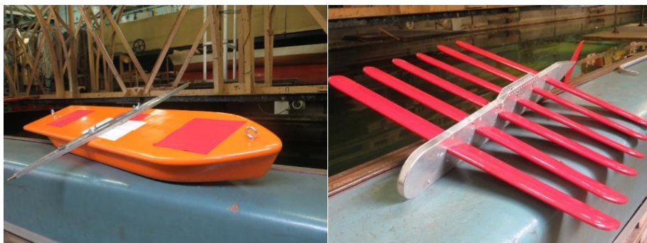
Рис.5. Действующий масштабный макетный образец волнового глайдера СПбГМТУ (модификация для опытового бассейна)
