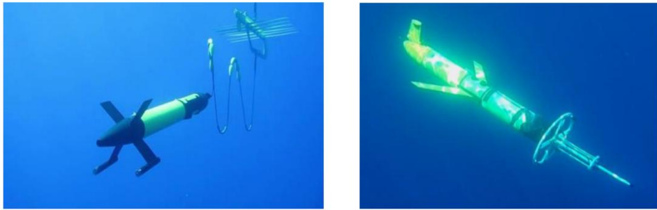
Рис. 6. Использование волнового и подводного глайдеров для решения задач сбора информации и обеспечения гидроакустической связи
