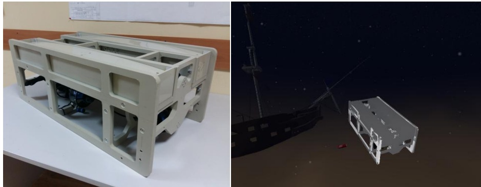
Рис. 2. Реальный аппарат и его виртуальная модель в симуляторе Gazebo.
