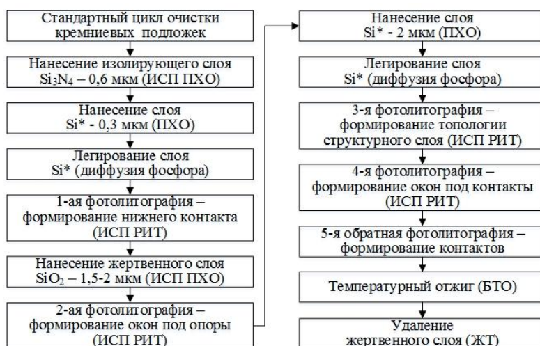
Рис. 1. Технологический маршрут изготовления ММА на пластине
