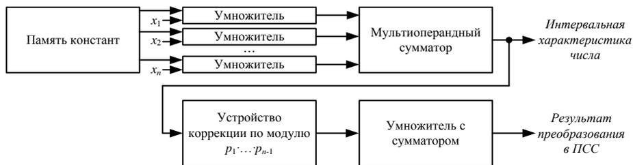
Рис. 5. Организация преобразователя кодов из СОК в ПСС
