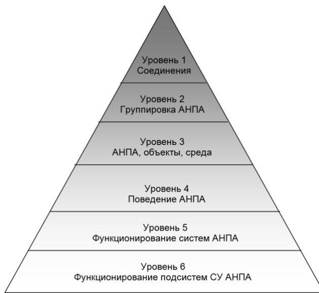
Рис. 1. Иерархическая схема задач с использованием АНПА
