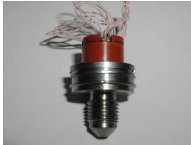
Рис. 4. Тензорезистивный КНС сенсор давления
