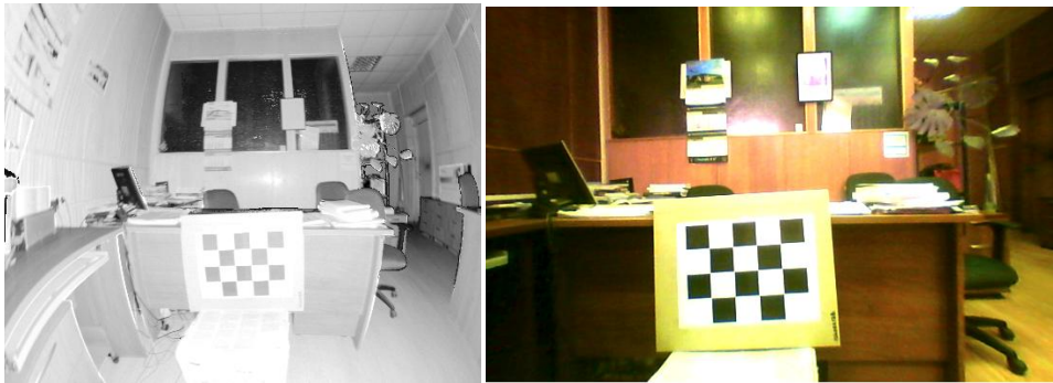
Рис. 3. Иллюстрация интенсивностей отражённого сигнала лазерного дальномера: слева – интенсивности отражённого сигнала, справа – фото того же участка комнаты
