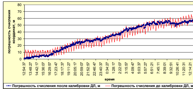
Рис. 3. Погрешность счисления координат АНПА до калибровки ДЛ и после калибровки
