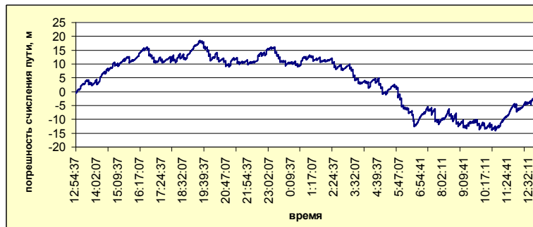
Рис. 5. Погрешность счисления пройденного пути АНПА после калибровки ДЛ
