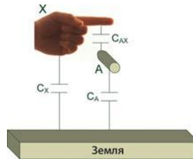
Рис. 10. Схема датчика с одним чувствительным элементом
