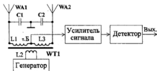
Рис. 7. Схема датчика двух антенной дифференциальной ёмкости
