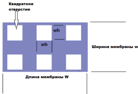
Рис. 8. Топологические размеры квадратных отверстий на подвижной металлической мембране
