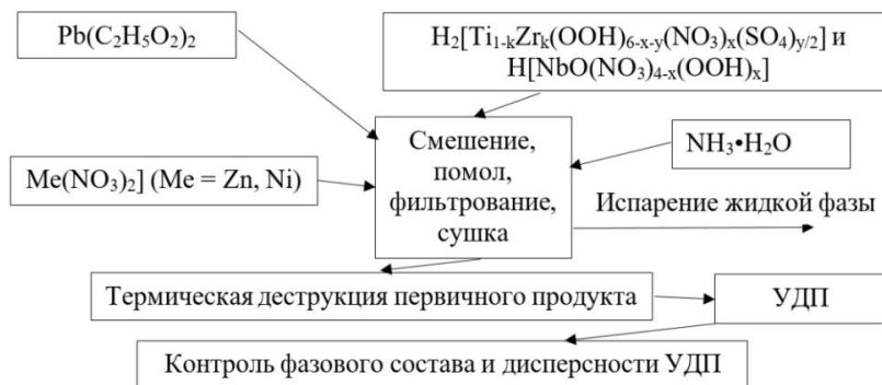
Рис. 2. Технологическая схема процесса синтеза УДП фаз состава \text{PbTi}_{1-x-y/2}\text{Zr}_{x-y/2}(\text{Nb}_{2/3}\text{Me}_{1/3})_y\text{O}_3 (Me = Zn, Ni)
